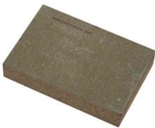
**BetonWood** Il pannello è realizzato in conglomerato cementizio tipo Portland e fibra di legno di Pino scortecciato, ad alta densità ( $\delta=1350 \text{ Kg/m}^3$ ) e con le seguenti caratteristiche termodinamiche: coefficiente di conduttività termica  $\lambda=0,26 \text{ W/mK}$ , calore specifico  $c=1,88 \text{ KJ/Kg K}$ , coefficiente di resistenza alla penetrazione del vapore  $\mu=22,6$  e classe di reazione al fuoco A2-fl-s1, secondo la norma EN 13501-1.
