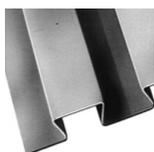
La lamiera grecata metallica **Beton metal sheet** a coda di rondine è una lastra di rinforzo in acciaio zincato autoportante, leggera, utilizzata per la casseforme ed il rinforzo di pavimenti in calcestruzzo o massetti di spessore limitato. Utilizzata in una struttura per pavimenti compositi, questa lamiera offre un'ottima soluzione per l'acustica, la protezione antincendio e funziona bene con i sistemi di riscaldamento e raffreddamento a pavimento all'interno del massetto.
